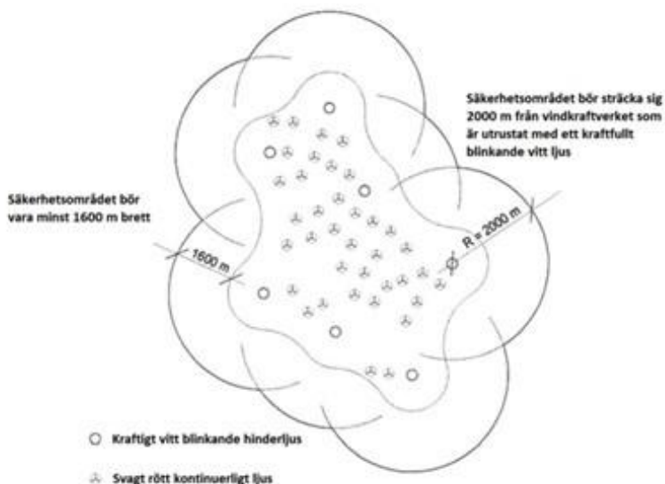
Bild 52. Exempel på placering av flyghinderljus när den högsta svepningspunkten för vindkraftsområdets kraftverk är över 150 meter ovanför markytan. Vindkraftverkens yttre ring bildas av blinkande vita flyghinderljus med hög effekt av B-typ.
