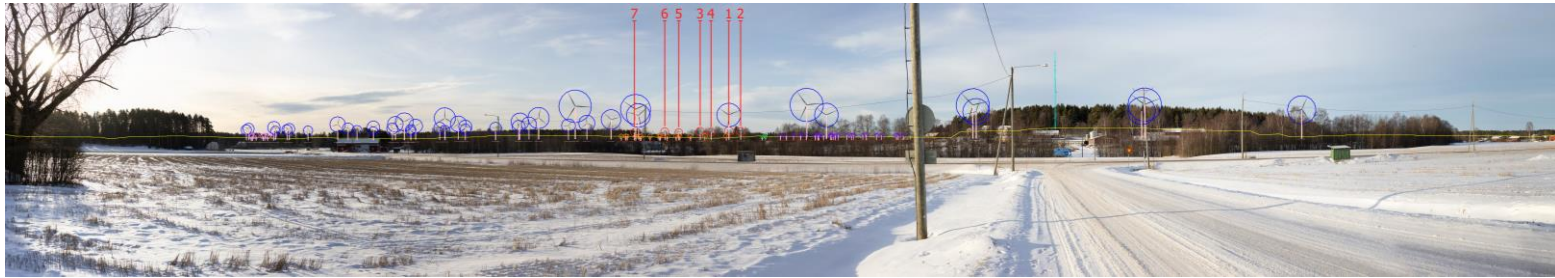
Kuva 98. Yhteisvaikutushavainnekuvaluonnos kuvauspisteestä 7. Kuva on otettu Pietarsaaren maalaiskunnan Permosta, kuvaussuunta lounaaseen. Etäisyys lähimpään Kaitsarin voimalaan on noin 12,6 kilometriä. Kaitsarin voimalat punaisella , Purmon voimalat sinisellä , Björkbackenin voimalat violetilla , Dalandetin voimalat oranssilla , Salo-Ylikosken voimalat pinkillä ja Jeppon voimalat vihreällä .
