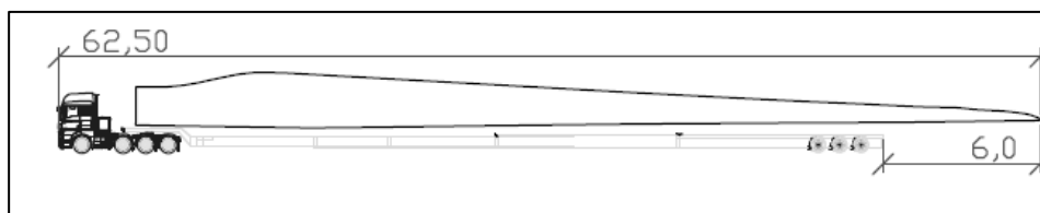
Kuva 60. Pisin erikoiskuljetus liittyy voimalan lapaan. Ajoneuvon pituutena on kuljetuspalveluksessa käytetty 62,5 metriä.
