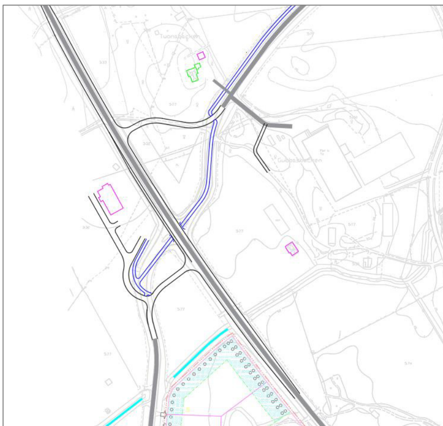
Bild 14. Utdrag ur trafikutredning – principlösningar i skede 1. Nuvarande anslutningar i korsningsområdet Ekolavägen-Pensalavägen staffleras, underfart för gång- och cykeltrafik förverkligas. Ingen konsekvens för Mirkas område.
